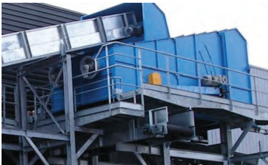
Figura 3. Esempio di separatore balistico
