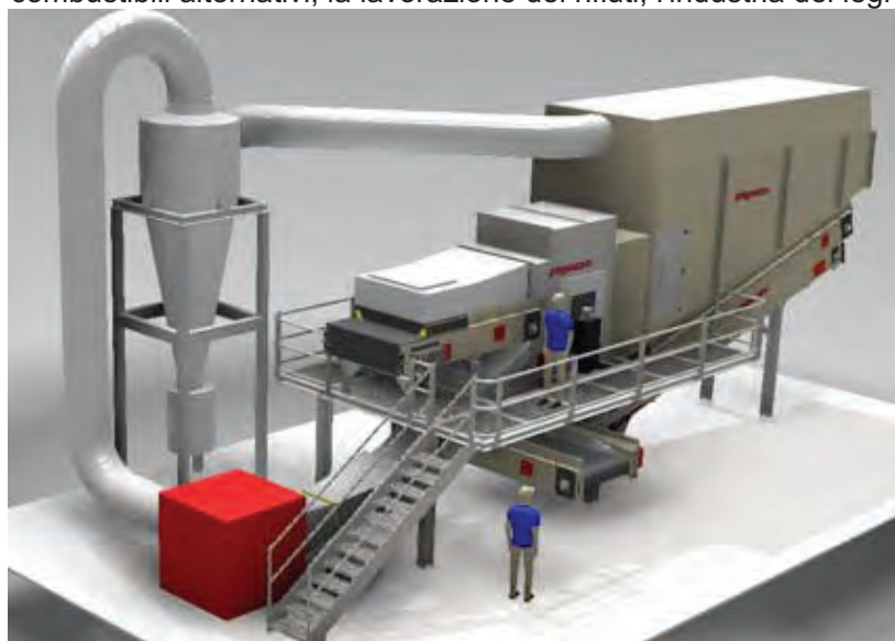
Figura 4. Esempio di separatore aeraulico
