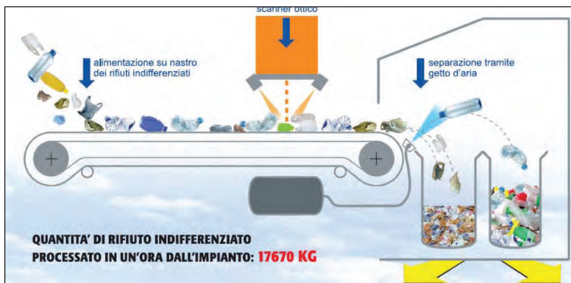
Figura 8. Schema esemplificativo delle sperimentazioni Ariel (Toscana) incentrate sul recupero delle plastiche
